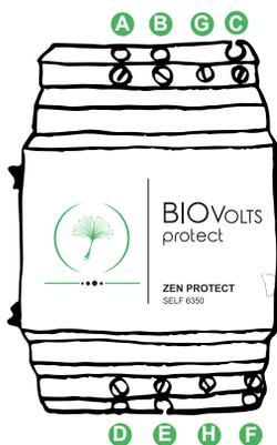
**7** Brancher le fil (blindé) de 16 mm<sup>2</sup> (côté B) sur la borne C du S6350 (ou sur la borne A pour une alimentation en 6 ou 10 mm<sup>2</sup>).
